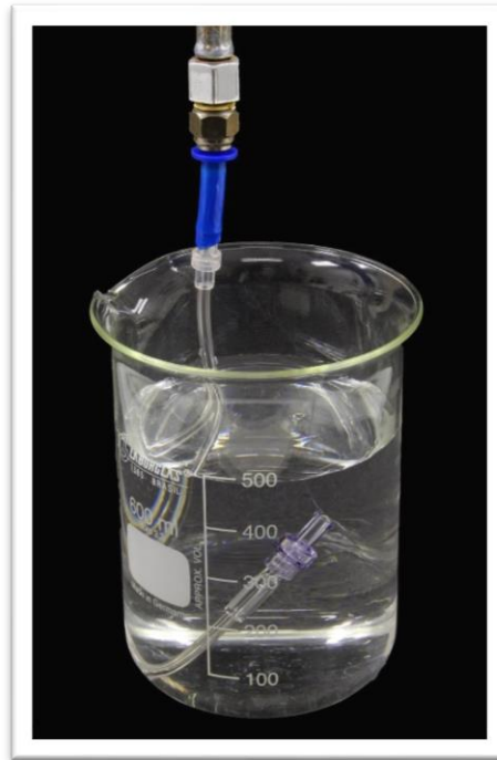
Figura 6 - Patient-set ® (Empresa Alko do Brasil Indústria e Comércio Ltda, Rio de Janeiro, RJ, Brasil) imerso em 500mL de água (Becker) e conectado ao tubo de poliuretano (PU - 0,8x50mm) - (Autoval ® – Válvulas e Equipamentos Indústria Ltda, Ribeirão Preto, SP, Brasil) acoplado ao compressor.
