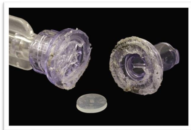
Figura 7 – Válvula antirrefluxo aberta e separada em duas partes e diafragma flexível exposto.
