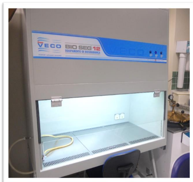
Figura 13 - Vista panorâmica da Cabine de Segurança Biológica Classe II – modelo Bio Seg 12 (Grupo VECO, Campinas, SP, Brasil).
